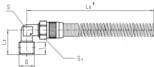
Raccord coudé à coiffe à visser(cylindrique) avec ressort
